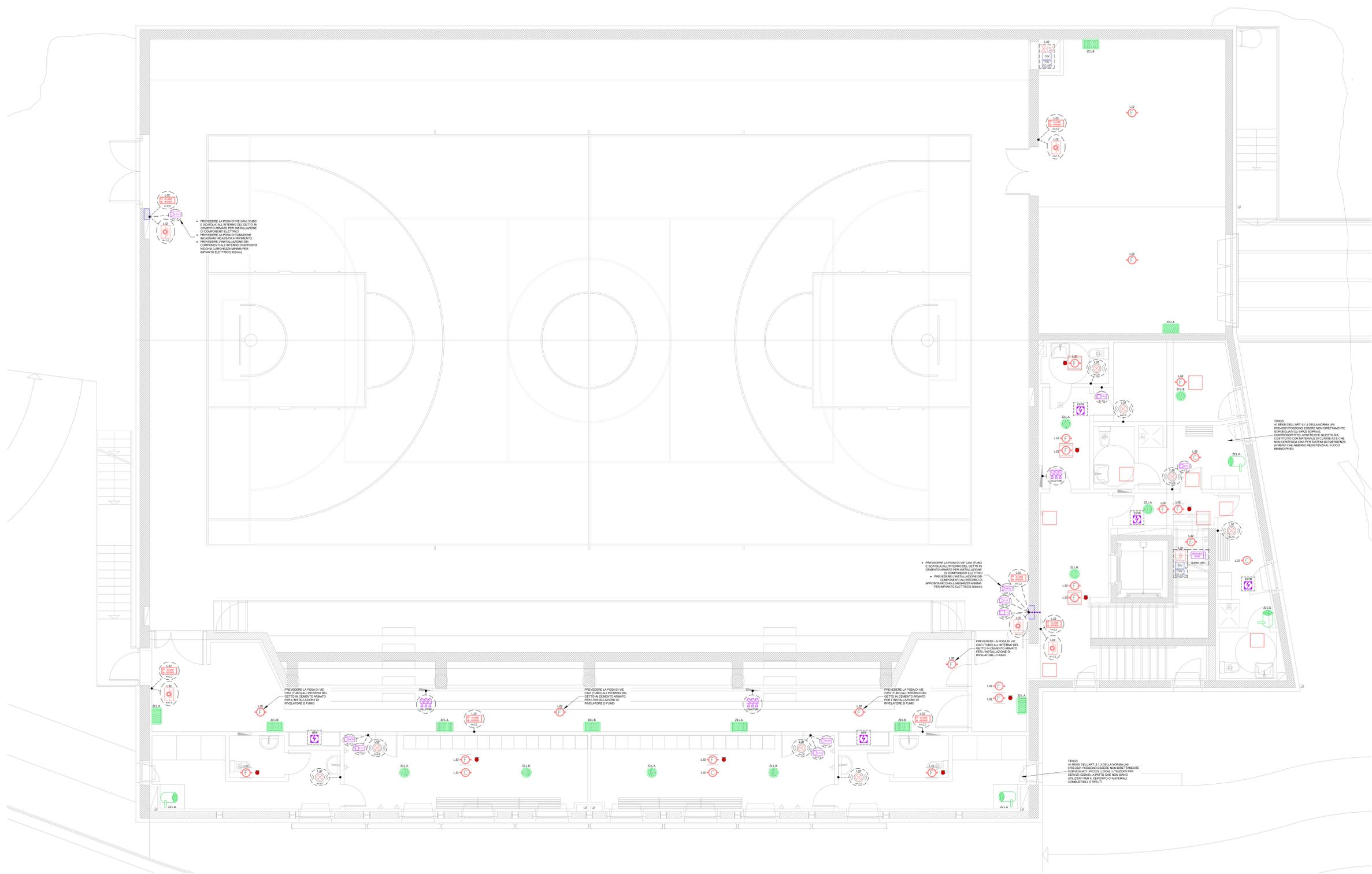
PREVEDERE LA POSIZIONE DEI CAVI FUMO E SINALTORE ALL'INTERNO DEL GETTO IN CEMENTO ARMATO PER INSTALLAZIONE DI TEMPORANNEI RILEVATORI
